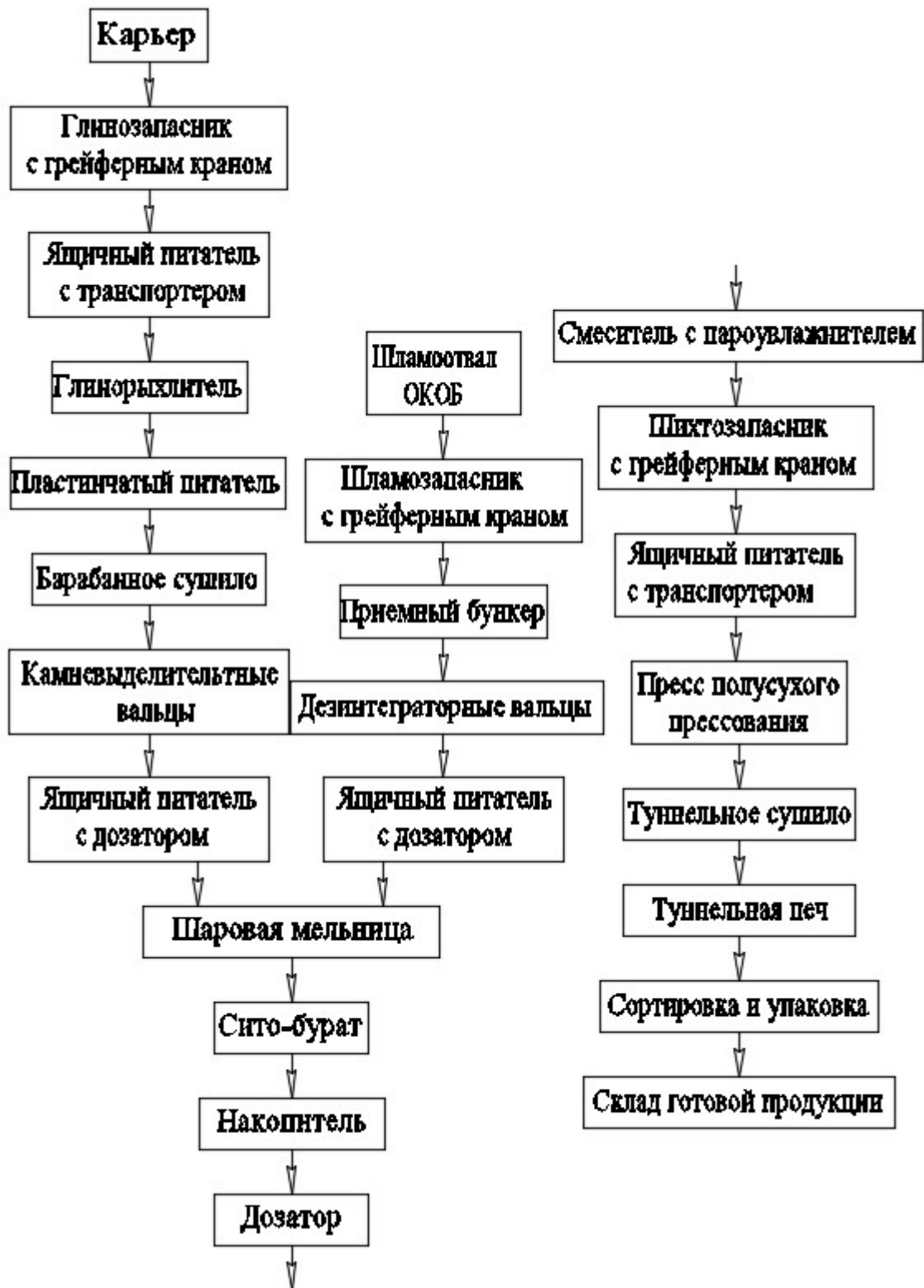
Рисунок 1– Технологический процесс изготовления керамического кирпича
