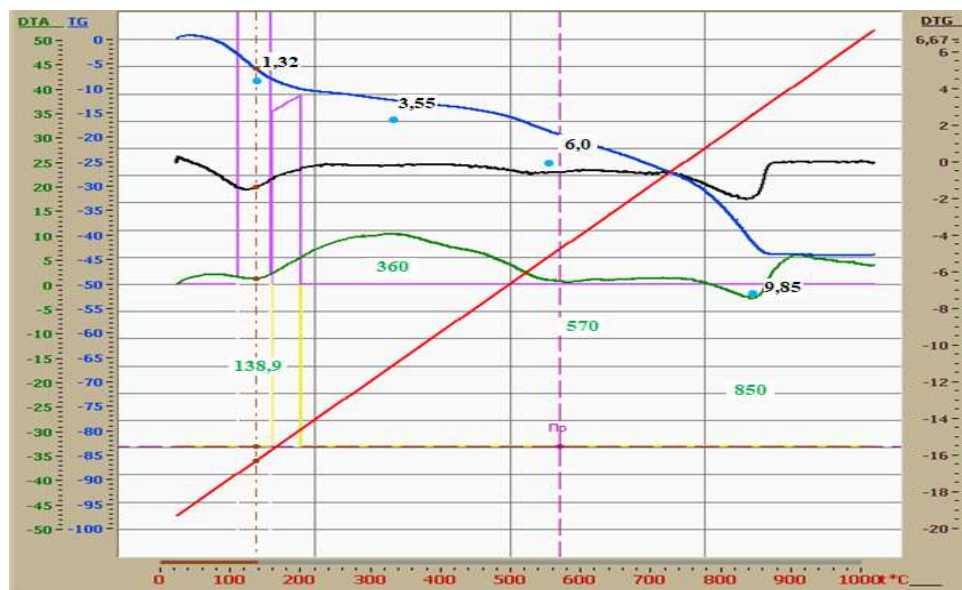
Рисунок 2.3 – Дериватограмма глины Бузулукского месторождения
