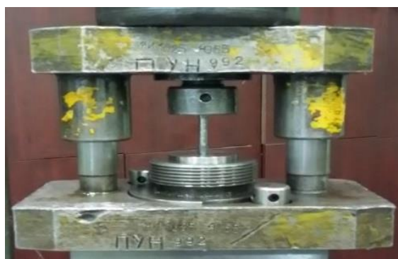
Рисунок 6 – Экспериментальный штамп переходов вытяжки. На схеме вытяжки в штампе обозначены: 1 – пуансон, 2 – полуфабрикат, 3 – твердосплавная вставка, 4 – нерабочая часть матрицы, 5 – стопорное кольцо, 6 – съемник
