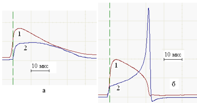
Рисунок 1 – Характерные осциллограммы напряжения (кривые 1) и тока (кривые 2) высоковольтного разряда в гидрофосфатах щелочных металлов: а – беспробойный разряд; б – пробой.
