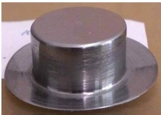
Рисунок 1 – Особенности холодной штамповки ниобия: а) изменение температуры отжига ниобия в зависимости от содержания примесей; б) полые осесимметричные детали из молибдена и ниобия
