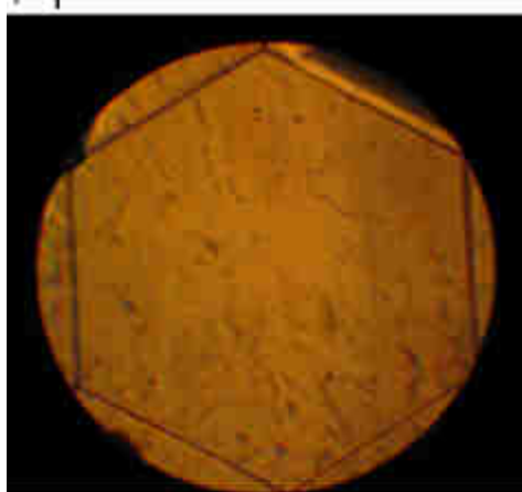
Рис. Микрофотография поверхности (а) и дифрактограмма (б) эпитаксиального слоя CdSe, выращенного на кристаллах слюды при температуре подложки 853, ( T_u=933 К)
