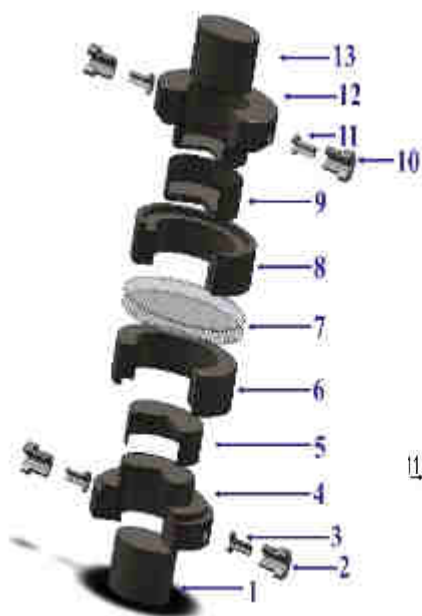
Рис. 2. Ячейка для измерения теплопроводности (сталь 12Х18Н10Т): 1–верхняя – «горячая» пластина; 6–нижняя пластина – «холодильник»; 2–кольцо–ободок; 3–боковая стенка (перемычка); 4–щель; 5–полость для исследуемого вещества; 8,7– абсолютная ( T_2 ) и дифференциальная ( \Delta T ) термопары; 9,10 – капилляры из нержавеющей стали 12Х18Н10Т; 11–впуск (газа или жидкости); 12–вывод (газа или жидкости); 13,14–вентили; 15–гайка.
